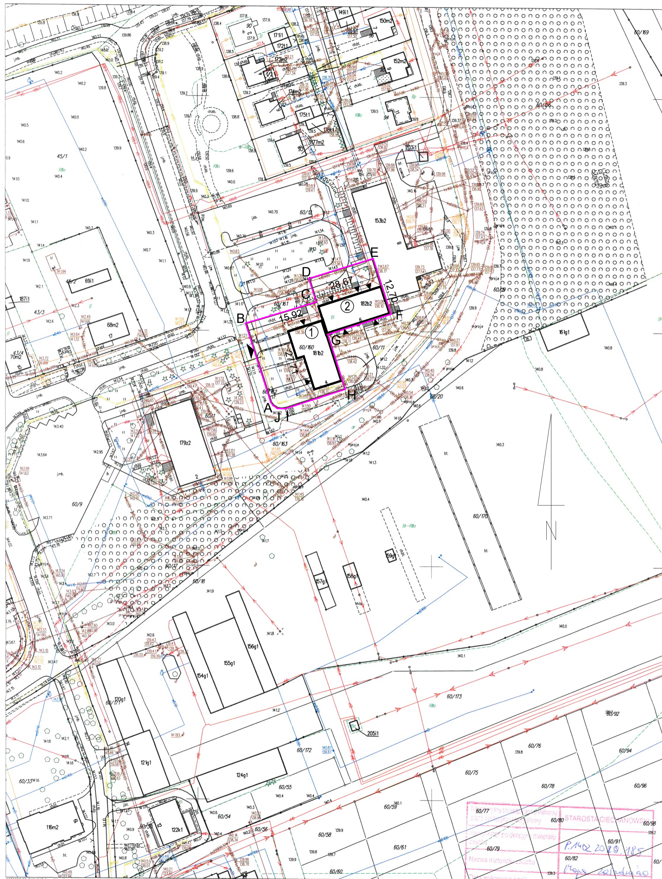
5863568.32; 7481017.61 (Współrzędne lewego dolnego narożnika w układzie PL-2000/1) (Wysokości na mapie w układzie PL-EVRF2007-NH) Fragment mapy zasadniczej Skala 1:1000 gmina Opinogóra Górna obręb Opinogóra Górna Mapa do celów opiniodawczych
