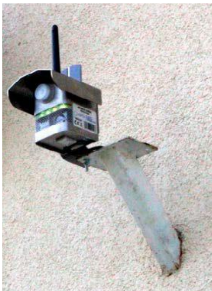
Fot. Czujnik zanieczyszczeń powietrza w Opinogórze Górnej.
