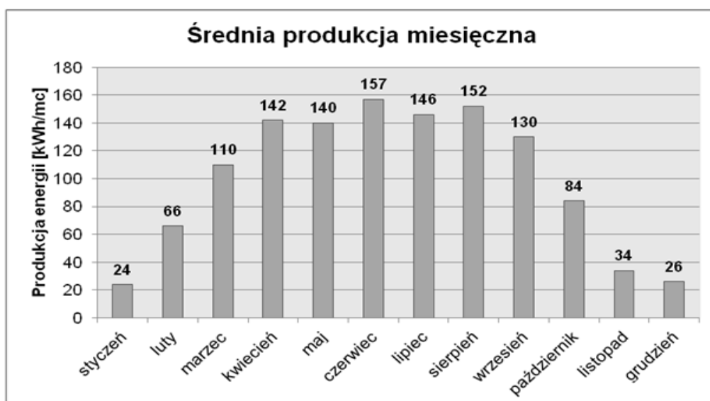
Wykres 9. Produkcja energii elektrycznej przez panele fotowoltaiczne
