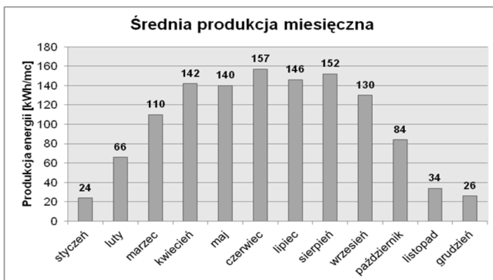
Wykres 9. Produkcja energii elektrycznej przez panele fotowoltaiczne
